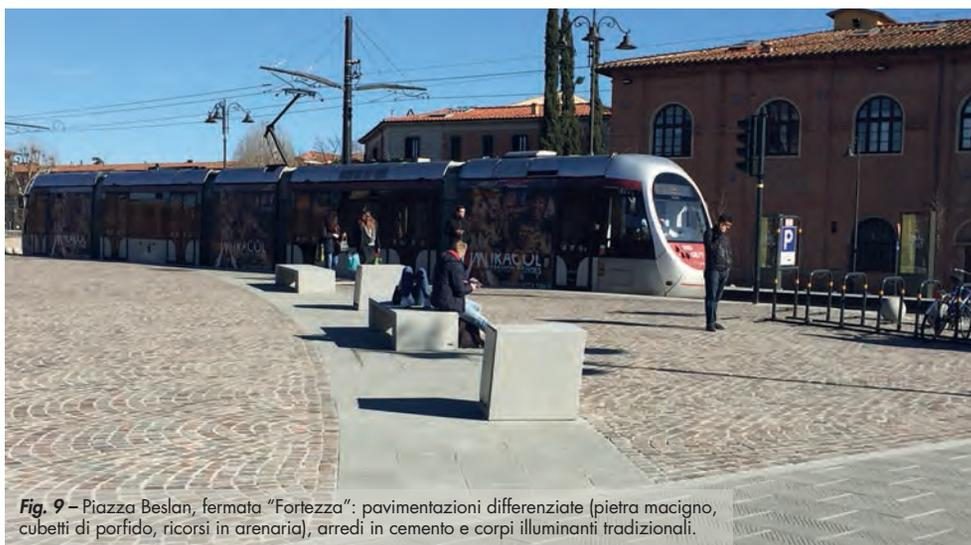
Fig. 9 – Piazza Beslan, fermata "Fortezza": pavimentazioni differenziate (pietra macigno, cubetti di porfido, ricorsi in arenaria), arredi in cemento e corpi illuminanti tradizionali.
