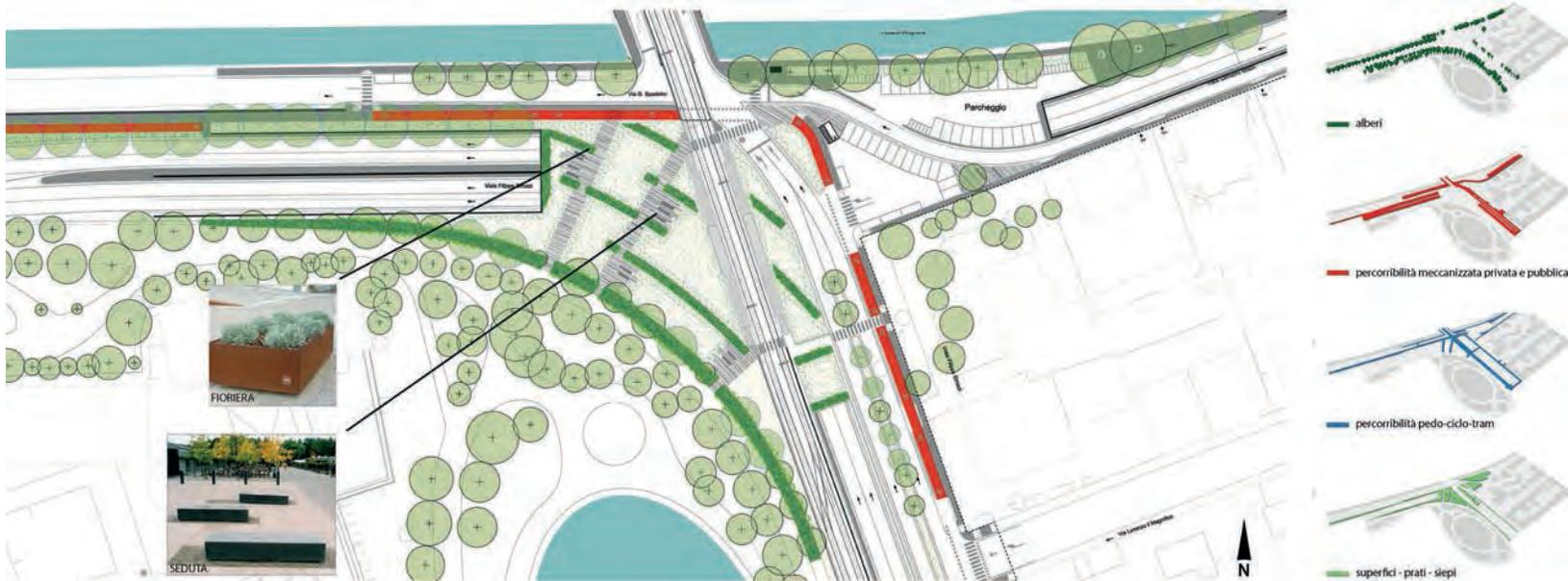
Fig. 3 – Progetto Largo Oriana Fallaci: integrazione tramvia, piste ciclabili e nuova pedonalità.
